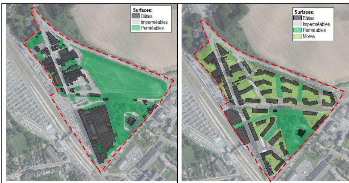
**Figure 21 : Imperméabilisation du périmètre de remembrement urbain en situation existante et projetée (ARIES 2018)**
